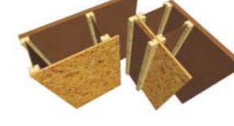
narożniki budynków budownictwo szkieletowe
