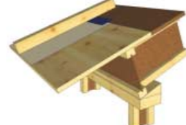
okap dachu z belką dwuteową zamontowaną skośnie do murłaty
