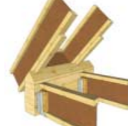
okap dachu z podpórką kątową
