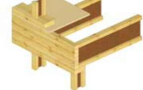
zakończenie stropu z belką boczną
