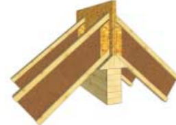
łączenie do kalenicy
