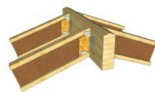
łączenie do kalenicy - łącznikami stalowymi
